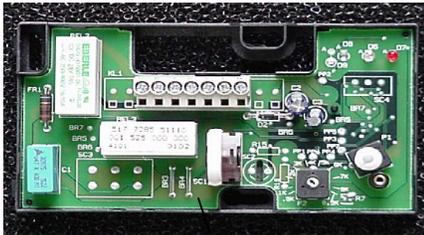
3. Grundplatte auf glatte Wand schrauben, Elektroverdrahtung nach Schaltplan vornehmen.
