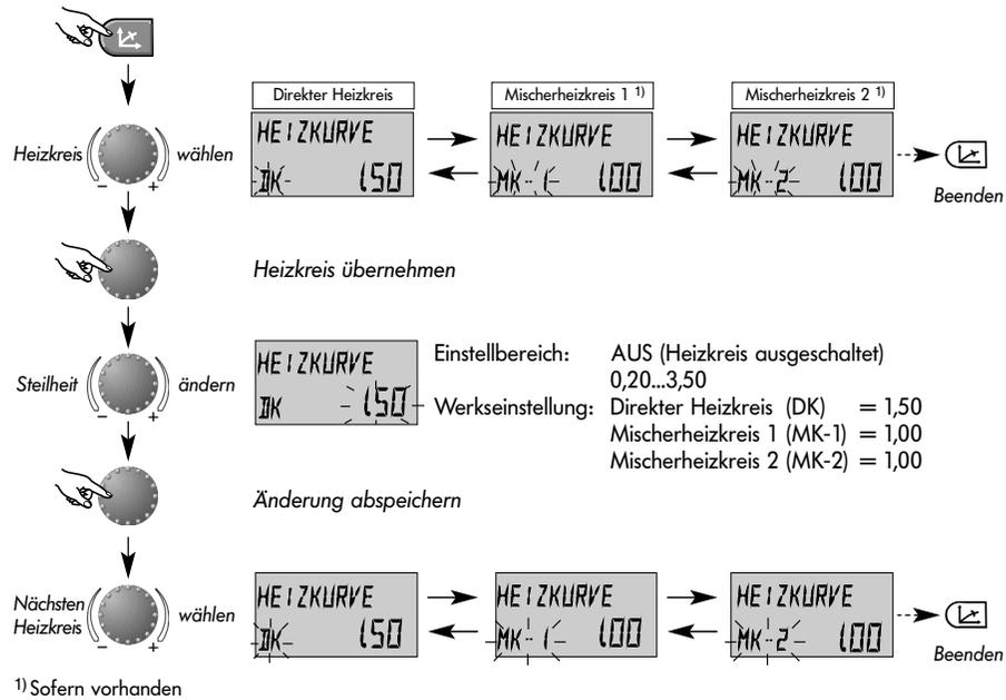
Taste zur Heizkurveneinstellung der witterungsgeführten Heizkreise.
