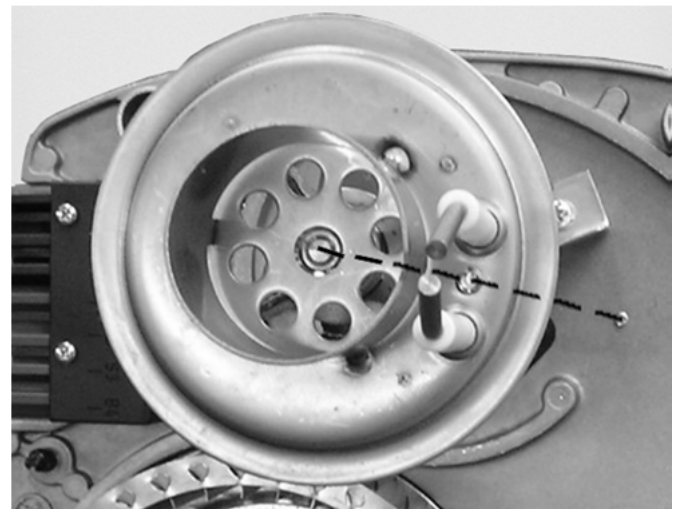
Abb. 38: Mischsystempositionierung und Ausrichtung Zündelectrode
