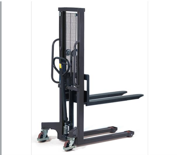
Für den gelegentlichen Einsatz als Hub- und Transportgerät. Stabile Profilstahl-Konstruktion mit Rohrschiebegriffen, pulverbeschichtet anthrazit RAL 7016. Hydraulikpumpe mit verchromten Kolben und Überlastventil. Betätigung über Zugdeichsel. Senkventil über Handhebel. 2 Lenkrollen, Räder Polyurethan-Bereifung und 2 Gabelrollen Nylon. Lenkrollen mit Feststeller. Lastschwerpunkt Abstand 585 mm. Gabelbreite 160 mm. Hub pro Deichselschlag 12,5 mm. 2 Jahre Garantie.
