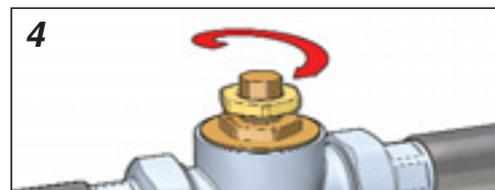
Blocage du réglage par contre-écrou
