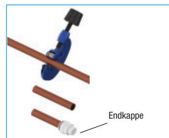
**Kupferrohre** mit Hilfe von Standardmetallrohrschneidern ablängen und sicherstellen, dass es keine scharfen Kanten, Grate, Längsriefen oder sonstige Beschädigungen aufweist. Die Endkappe ist ein nützliches Zubehörteil, um bei Reparaturen sowie Dichtheitsprüfungen das Rohr einfach und effektiv vorübergehend zu verschließen.
