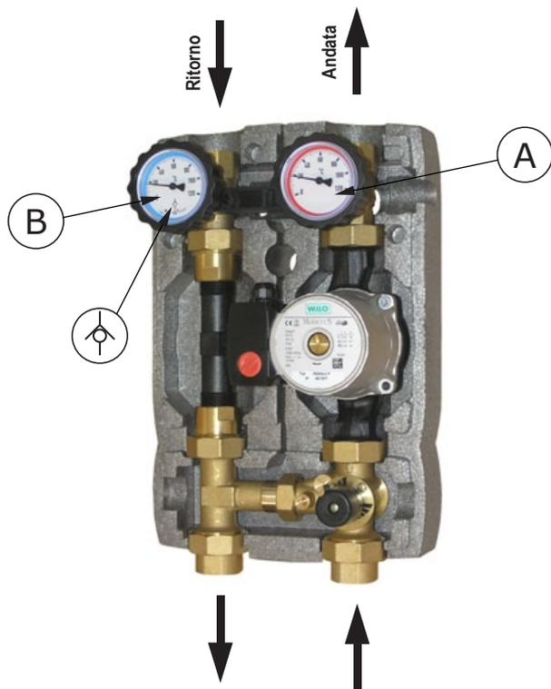
Les modules hydrauliques MODVLVSEnergy sont spécifiques pour la comptabilisation de l'énergie pour les installations de chauffage et de refroidissement centralisées. Ces modules, grâce à deux vannes d'arrêt sur la voie de retour, permettent un montage facile du compteur d'énergie. La deuxième sonde de température est placée directement dans la vanne d'arrêt de la voie de départ, sans aucun adaptateur ou puits.
