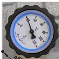
Pour le remplissage et le vidange du système il faut exclure le CAR en tournant le volant avec thermomètre bleu de 45° dans le sens des aiguilles d'une montre, à commencer par la position de complète ouverture (voir illustration à côté).
