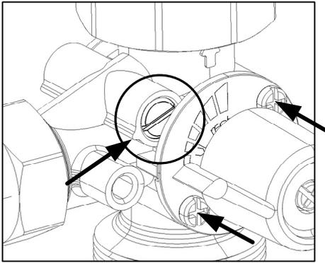
Les flèches montrent la référence du by-pass en position tout ouvert et les vis de fixation du couvercle indicateur et de la tige de réglage.
