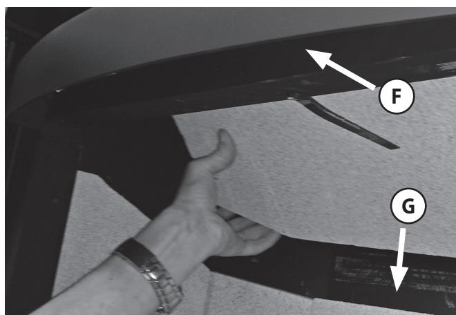
Überblick über die Elemente der Vermiculite-Rauchgasumlenkung:
