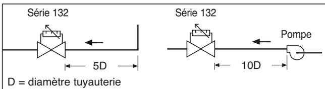
La vanne peut être installée dans n'importe quelle position du moment que l'on respecte le sens du flux indiqué sur le corps de la vanne. Elle peut être montée indifféremment sur des tuyaux horizontaux ou verticaux.
