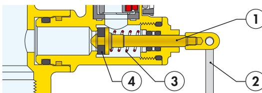
L'anneau d'actionnement (2) est à faible conductibilité thermique afin d'éviter les brûlures durant l'ouverture du débitmètre au cas où le fluide traversant la vanne serait à une température élevée.
