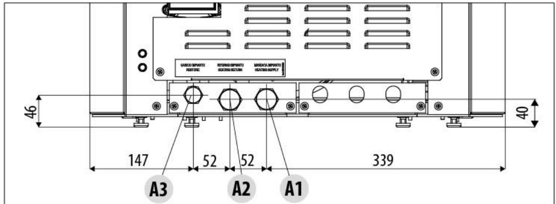
A1 = Wasservorlauf Heizung 3/4" M
