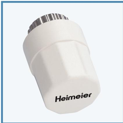
Der thermische Stellantrieb EMO T ist ein Zweipunktantrieb für den Anschluss an Temperaturregler mit Zweipunkt-Ausgang, z. B. HEIMEIER Raumthermostat, Thermostat P oder Radiocontrol F Funksystem für Fußbodenheizung.
