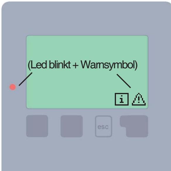
Erkennt der Regler eine Fehlfunktion, so blinkt das rote Licht und zusätzlich erscheint das Warnsymbol im Display. Liegt der Fehler nicht mehr vor, ändert sich das Warnsymbol in ein Infosymbol und das rote Licht blinkt nicht mehr. Nähere Informationen zum Fehler erhalten Sie durch Drücken der Taste unter dem Warn- bzw. Infosymbol.
