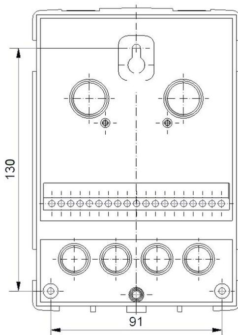
5. Mittels Bohrmaschine und 6er Bohrer 3 Löcher an den angezeichneten Stellen in die Wand bohren und die Dübel eindrücken.
