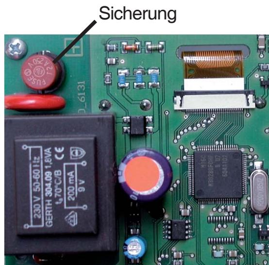
Hat der Regler trotz eingeschalteter Netzspannung keine Funktion und Anzeige mehr, so ist es möglich, dass die interne Gerätesicherung defekt ist. Dann das Gerät öffnen, alte Sicherung entfernen und überprüfen. Die defekte Sicherung wechseln, externe Fehlerquelle (wie z.B. Pumpe) finden und austauschen.
