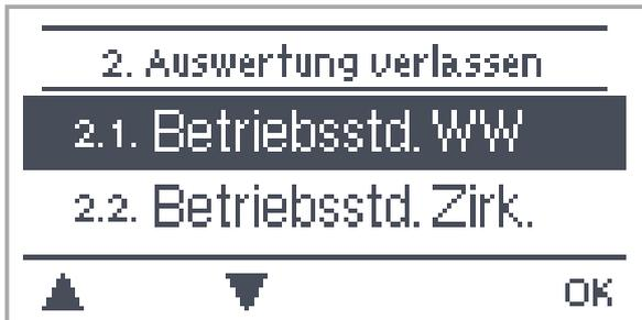
Das Menü “2. Auswertungen” dient zur Funktionskontrolle und Langzeitüberwachung der Anlage.
