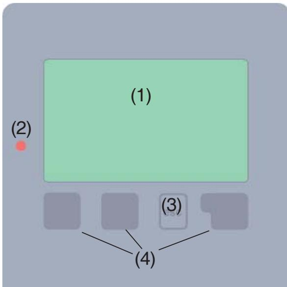
Das Display (1) mit umfangreichen Text- und Grafikmodus ermöglicht Ihnen eine einfache und fast selbsterklärende Bedienung des Reglers.
