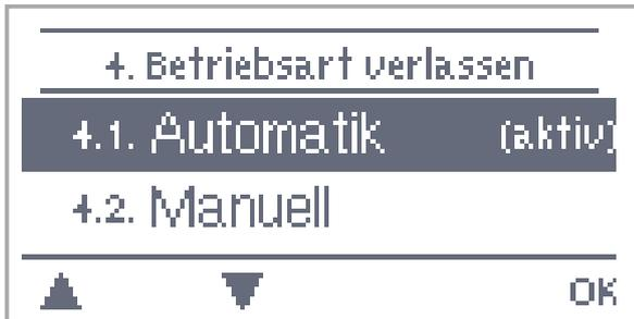
Im Menü "4. Betriebsarten" kann der Regler neben dem Automatikbetrieb auch ausgeschaltet oder in einen manuellen Betriebsmodus versetzt werden.
