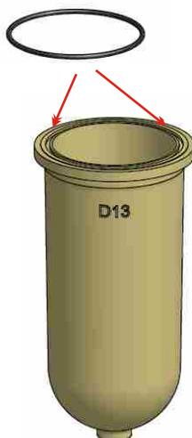
Positionner le joint torique dans la rainure du godet (veiller à ce que celui-ci soit correctement positionné) et revisser le godet à l'aide de l'écrou tournant.
