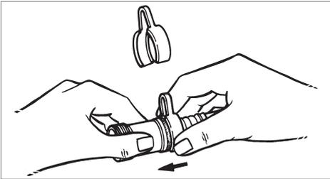
Demontageklammer auf Schiebering stecken. Roten Sicherungsring damit radial zusammendrücken und Schiebering Richtung Fitting verschieben.
