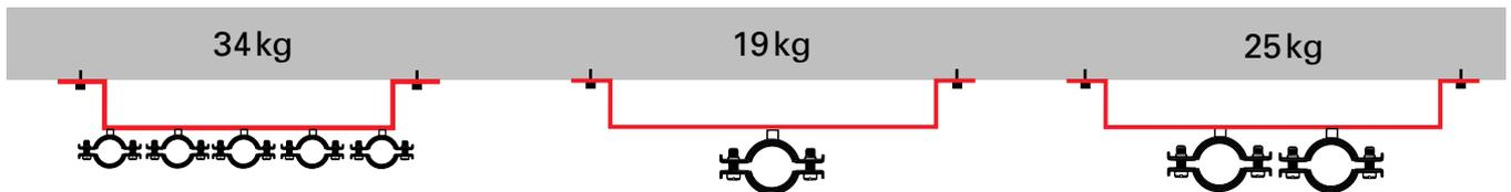
Deckenhalter l = 300 mm mit unterschiedlicher Lastverteilung
