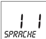
Die rechte Ziffer zeigt die aktuelle Einstellung an. Der Parameter wird zusätzlich noch in Klartext angezeigt. Z. B. steht die Anzeige / / für Parameter 1 (Sprache) mit Einstellung 1 (Deutsch).
