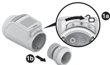
1. Ventilaufsatz vom Heizkörperregler trennen. Dazu den Schieber in Richtung
