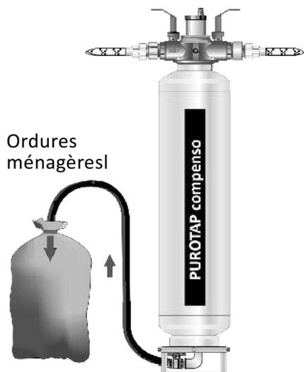
1. Fermer le robinet à boisseau sphérique de sortie, brancher un tuyau sur le robinet de vidange et en introduire l'autre extrémité dans le sac de récupération fourni. Rincer la résine à l'aide de l'eau sous pression du réseau d'alimentation d'eau sanitaire.
