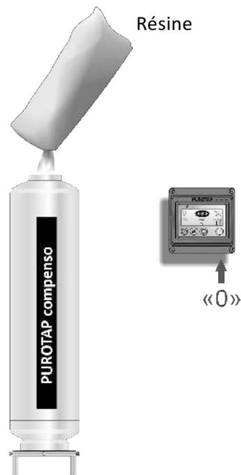
3. Remplir la colonne avec de la résine neuve, revisser la tête, rebrancher les flexibles et remettre le compteur à zéro (voir instructions).
