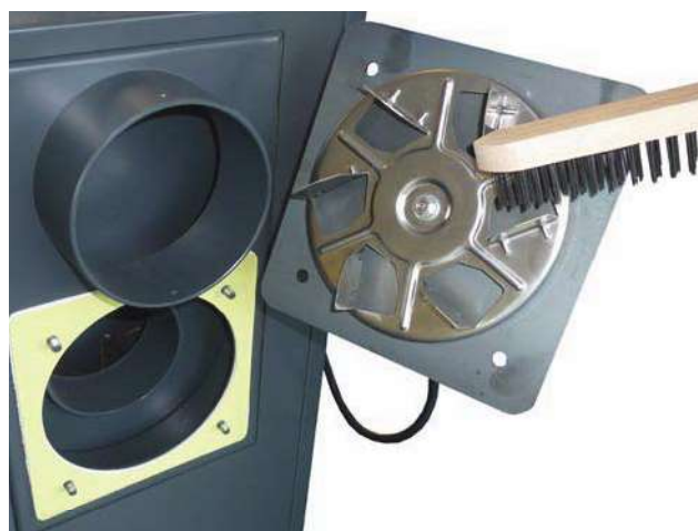
Die Reinigung des Umlaufrad und die Kontrolle des Schaufels bei Saugzugventilator (bei P31)
