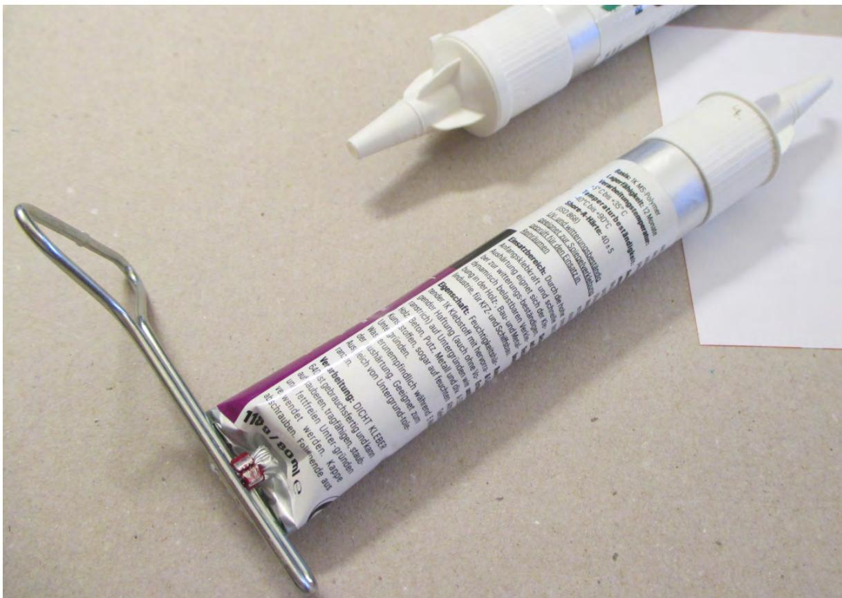
Der Tubenschlüssel wird über den freiliegenden Folienclip gezogen und eingedreht. Durch gleichmäßiges Nachdrehen ist eine praktische und saubere Entleerung des Folienbeutel möglich.
