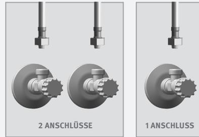
**SICHERSTELLEN, DASS DER (DIE) FILTER ZWISCHEN DEM (DEN) FLESCHLÄUCH(EN) UND DEM (DEN) Absperrventil(EN) (ECKVENTIL) (NICHT IM LIEFERUMFANG) INSTALLIERT IST (SIND).**
