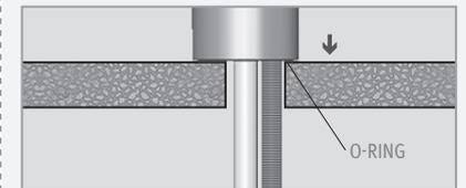
2 Dichtung, Scheibe und Schraubenmutter über den Flexschlauch schieben und Armatur durch festziehen der Sechskantmutter am Gewindestab befestigen.
