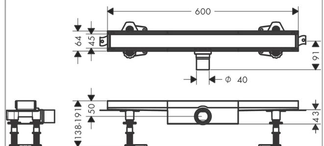
**RainDrain Compact****Caniveau de douche linéaire 600 avec hauteur d'encastrement 43 mm à carreler**
