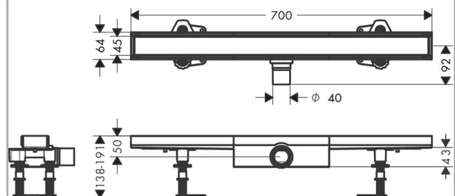
**RainDrain Compact****Caniveau de douche linéaire 700 avec hauteur d'encastrement 43 mm à carreler**
