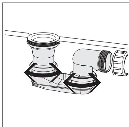
**INFO! Dieser Ablauf verfügt über zwei drehbare Gelenkstellen.**
