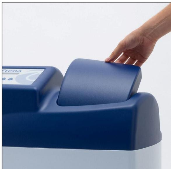
Die optimale Füllmenge liegt zwischen  $\frac{1}{3}$  und  $\frac{2}{3}$  des Salzbehälters. Eine zu geringe Salzmenge führt zu einer ineffizienten Regeneration des Harzes und somit zu nicht vollständig weichem Wasser. Eine zu hohe Tankfüllung kann zu Salzkrustenbildung im Salztank führen. Bei Vermutung von Salzbrücken:
