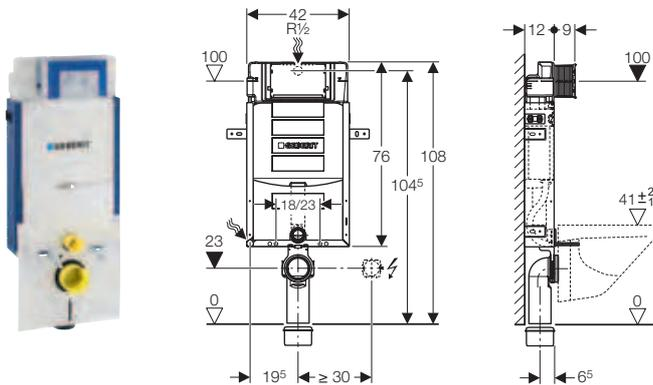
✓ Zum Einbau in eine teilhohe oder raumhohe nass gemauerte Vorwand vor einer Massivwand
