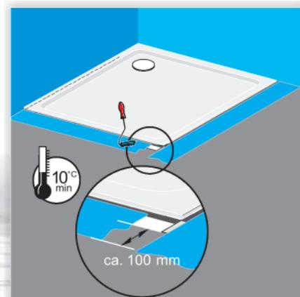
7. Nasszellenprimer oder Dichtschlämme auf das umlaufende Abdichtband auftragen.
