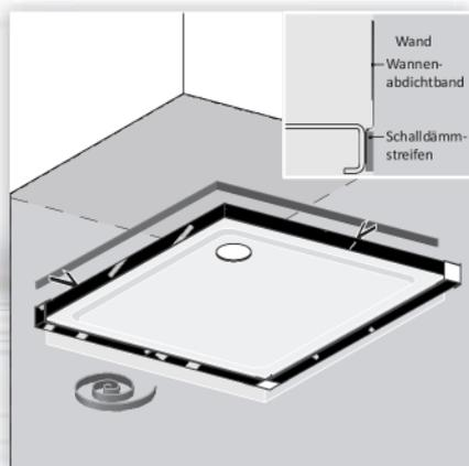
6. Optional mit Schalldämmband ausrüsten.
