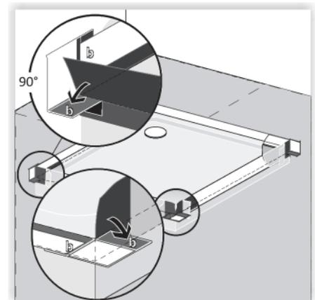
5. Die aufgeklebten Dichtecken besitzen flexible Gelenke und passen sich leicht an!
