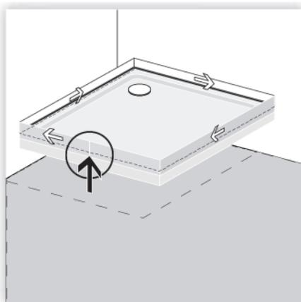
3. Wannenabdichtband umlaufend **an die Unterkante des Distanzbandes** andrücken und mit Verbinder schließen.
