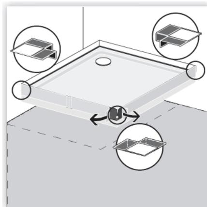
4. Übergänge Wand/Boden- und Boden/Boden mit Hilfe von Dichtecken absichern.
