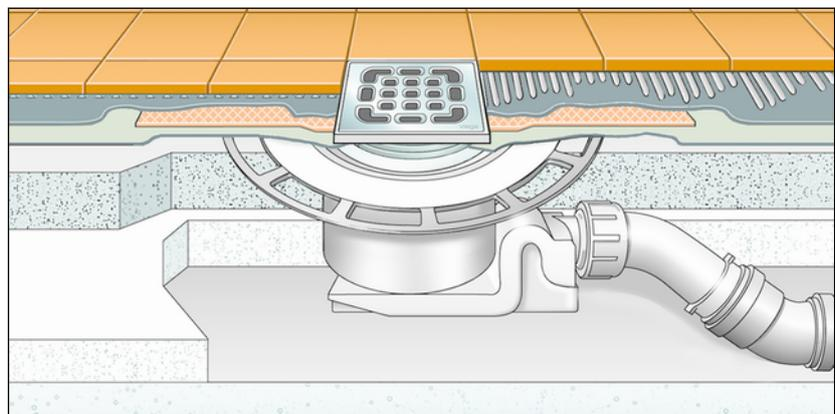
Abb. 3: Schema einer Verbundabdichtung
