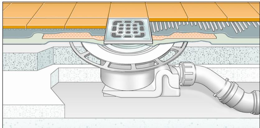
Abb. 4: Schema einer Verbundabdichtung
