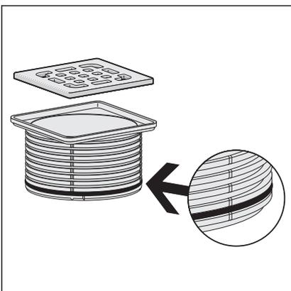
**INFO! Die Rückstaudichtung muss gesetzt werden, wenn von außerhalb des Aufsatzes keine Feuchtigkeit in den Ablauf laufen soll, von unten aber Wasser in den Ablauf drücken könnte. Im Regelfall wird keine Rückstaudichtung montiert, damit im Rahmenbereich anfallendes Wasser (z. B. durch eine undichte Silikonnaht) abfließen kann. In folgenden Fällen wird eine Rückstaudichtung montiert:**
