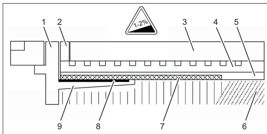
Abb. 5: Aufbauschema der Verbundabdichtung – Estrichgefälle min. 1–2 %
