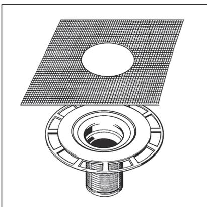
Wenn eine Verbundabdichtung erfolgen soll, wird ein passendes Aufstockelement mit Abdichtungsmanschette benötigt.
