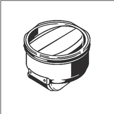
Advantix-Abflüsse können mit einer zusätzlichen Geruchssperre ausgestattet werden, die den Ablauf auch dann geruchssicher verschließt, wenn das Sperrwasser im Geruchverschluss ausgetrocknet ist. Geruchbelästigungen werden so auch bei selten benutzten Abflüssen verhindert. Geruchssperren finden Sie im Katalog.
