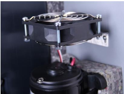
Der Lüfter kühlt die Pumpe durch einen gleichmäßigen Luftstrom. Falls kein Dauerbetrieb vorgesehen ist, kann der Lüfter auch elektronisch abgeklemmt werden. Dies spart ca. 6W Leistung ein. Falls dann dennoch mal die Pumpe im Dauerlauf mit hohem Gegendruck betrieben wird und sich die Pumpe zu stark erwärmt, schaltet der integrierte Pumpentempersensor die Pumpe ab. (Die Pumpe schaltet sich nach einer Abkühlzeit selbständig wieder ein.)
