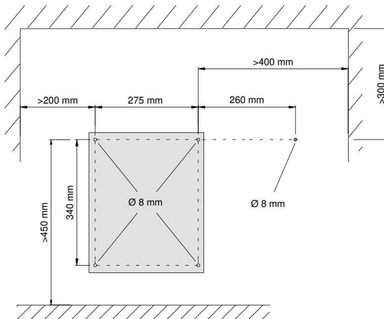
Die Befestigungen des *SMT E* mittels Ø8 mm Dübel und Schrauben ist waagrecht auszuführen. Auf Höhe der oberen Befestigungsbohrungen liegt in einem Abstand von 260 mm die Bohrung für die Befestigungsschelle des Ausdehnungsgefäßes.
