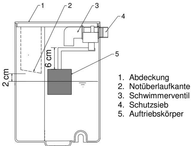
Das Schwimmventil hält den Wasserstand im Nachspeisebehälter immer konstant. Der maximale Wasserstand muss beim Schließen des Schwimmventils ca. 2-3 cm unterhalb der Notüberlaufkante (Behälterrückseite) sein. Der korrekte Abstand des Auftriebskörpers zur Hebeloberkante ist ab Werk mit 6 cm eingestellt.
