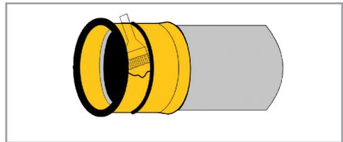
**2.** Obere Hälfte der Rollfix-Verbindung mit Gleitmittel dünn und gleichmäßig einstreichen.
