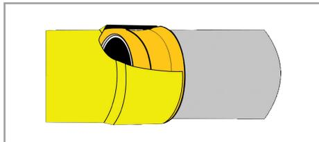
**5.** Durch Eindrücken des Spitzendes, tritt die gewünschte Rollfunktion in Kraft. Diese ist mit Eintauchen der Ringwulst unter dem Rollfix erreicht.
