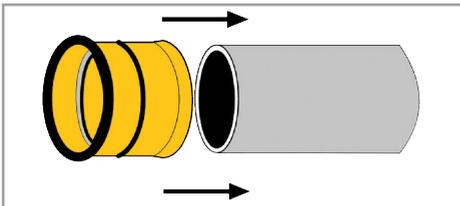
**1.** Rollfix mit Wulst nach oben, bis Anschlagkante auf Spitzende schieben.
