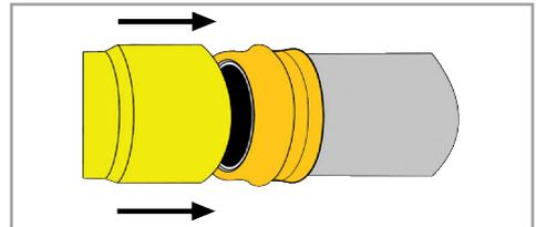
**4.** Der entstandene vordere Ansatz in Muffe einsetzen bis Wulst auf dem Muffenrand aufliegt.
