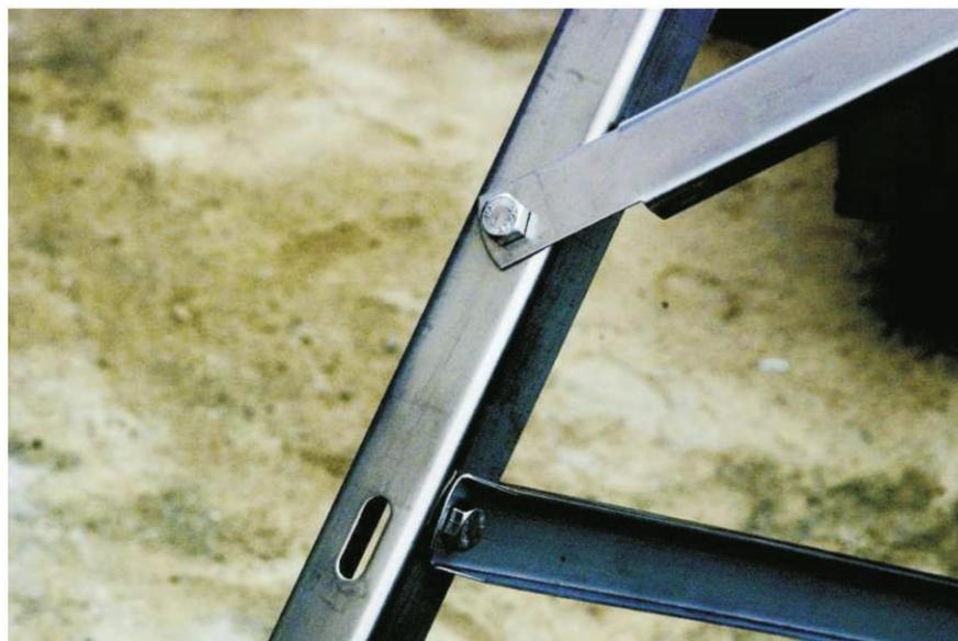
Dans la partie inférieure du kit de montage, installez le rail avec les supports de tubes sous vide (13). Dans ce but, utilisez les composants (9) (17).
