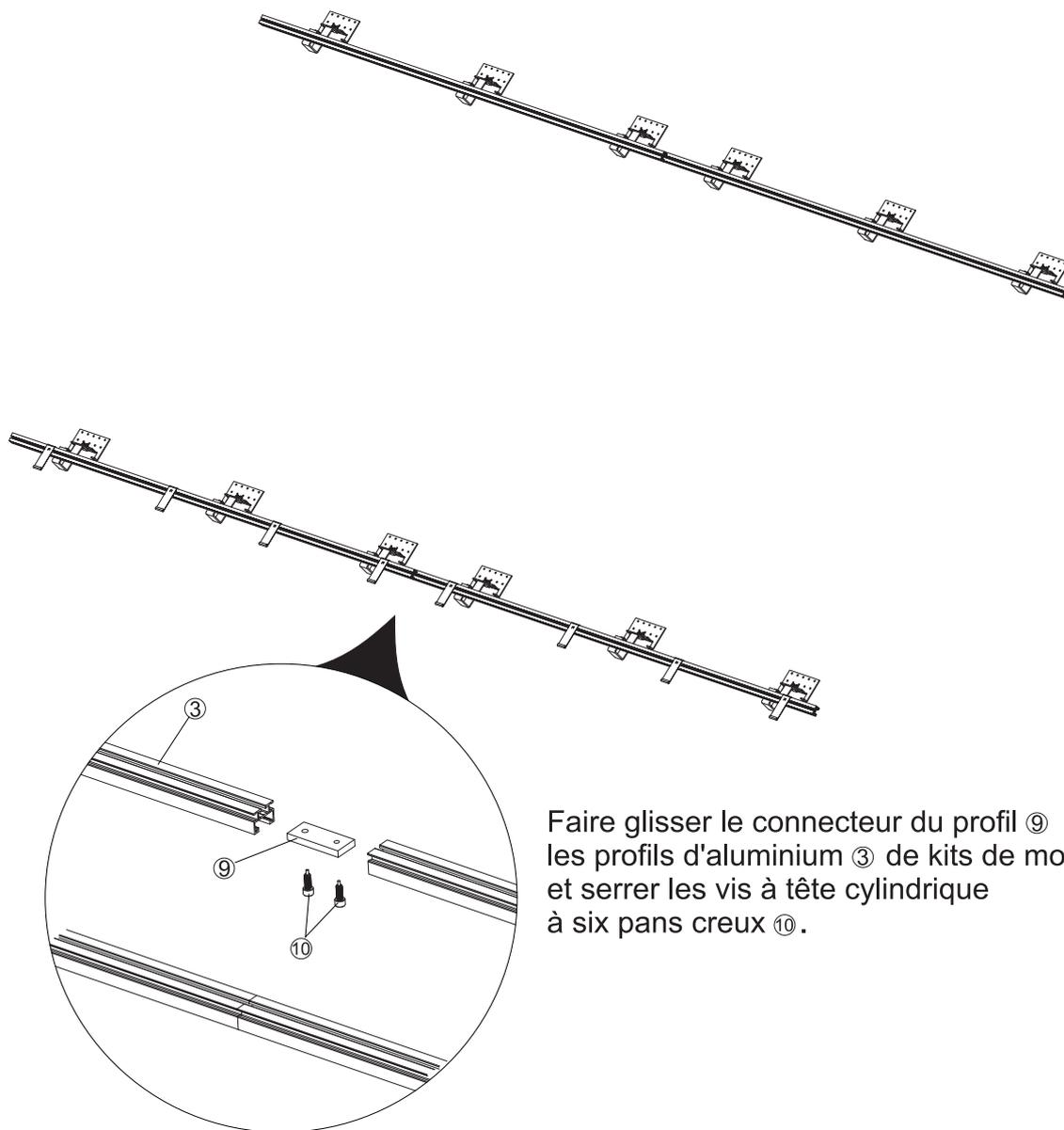
Faire glisser le connecteur du profil ⑨ dans les profils d'aluminium ③ de kits de montage et serrer les vis à tête cylindrique à six pans creux ⑩.
