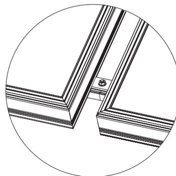
5. Les collecteurs sont fixés des côtés avec un embout ⑥ et des vis ⑪.
