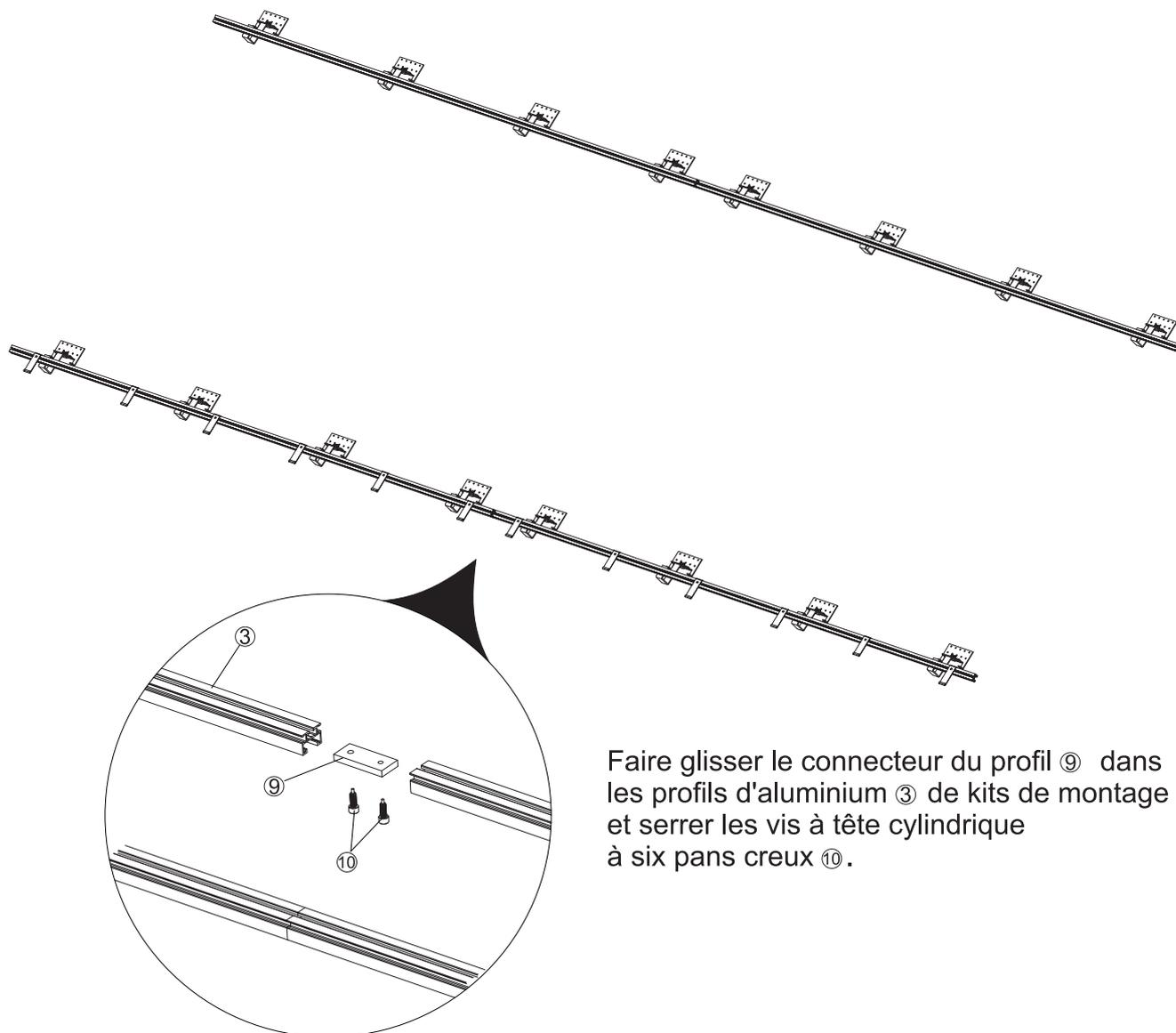
Faire glisser le connecteur du profil ⑨ dans les profils d'aluminium ③ de kits de montage et serrer les vis à tête cylindrique à six pans creux ⑩.
