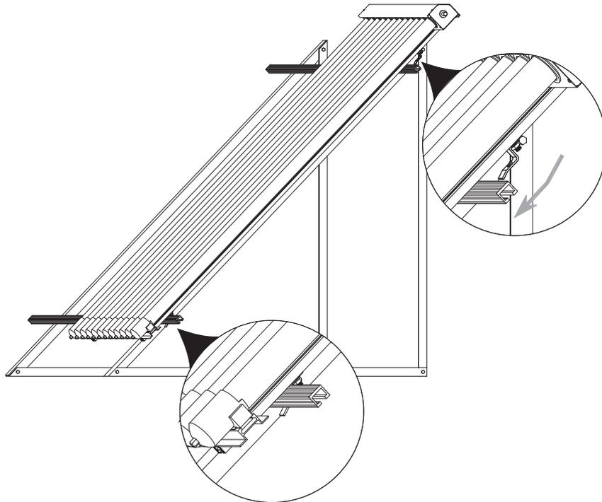
Placer le capteur sur les poutres horizontales, baisser le capteur haut et visser fort.
