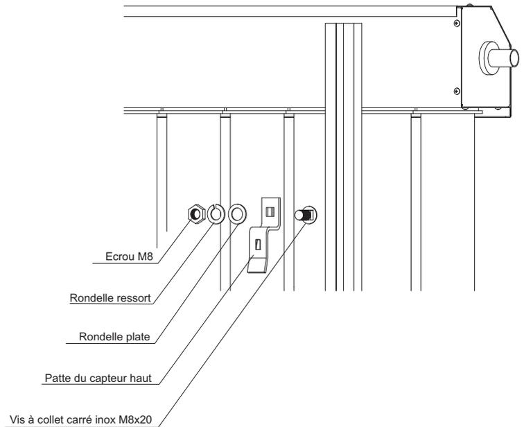
Installer la patte haute en utilisant les vis à collet carré M8x20 et visser légèrement.
