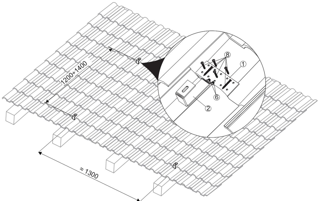
Fixer les crochets et remettre les tuiles en place.
