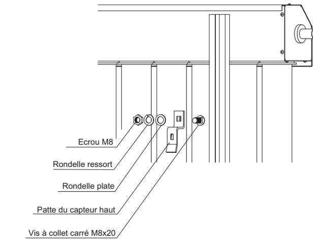
Installer la patte haute en utilisant les vis à collet carré M8x20 et visser légèrement.
