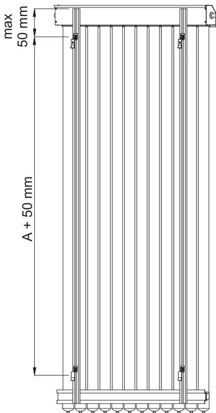
**!** **Attention: Pendant le montage des pattes, Il est interdit de s'appuyer sur les tubes!**
