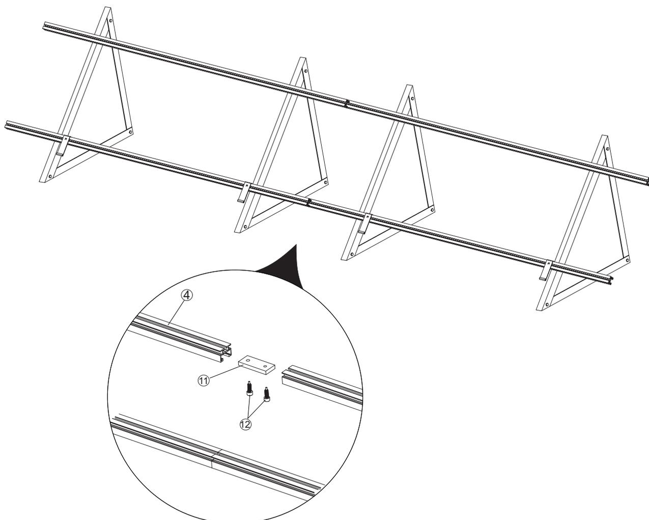
Faire glisser le connecteur du profil dans les profils d'aluminium ⑪ de kits de montage ④ et serrer les vis à tête cylindrique à six pans creux ⑫.
