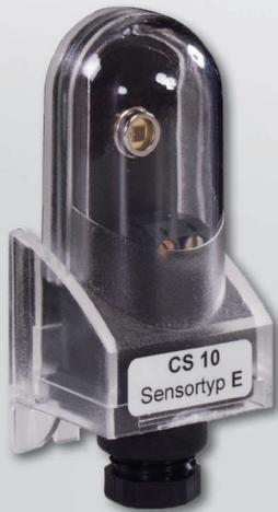
La cellule solaire CS10 sert à mesurer la puissance instantanée du rayonnement solaire. Le courant de court-circuit augmente proportionnellement à l'intensité du rayonnement solaire. La sonde peut s'utiliser, selon le régulateur employé, pour effectuer un contrôle de vraisemblance additionnel ou pour qu'elle ait un effet direct sur le régulateur. Le câble de branchement peut se rallonger jusqu'à 100 m.
