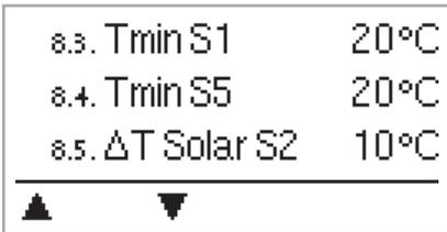
Das Menü „8. - Servicewerte“ dient im Fehlerfall z.B zur Fern-diagnose durch den Fachmann oder Hersteller.
