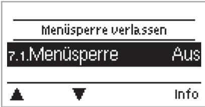
Durch das Menü „7. - Menüsperr“ kann der Regler dagegen gesichert werden, dass die eingestellten Werte unbeabsichtigt verstellt werden.
