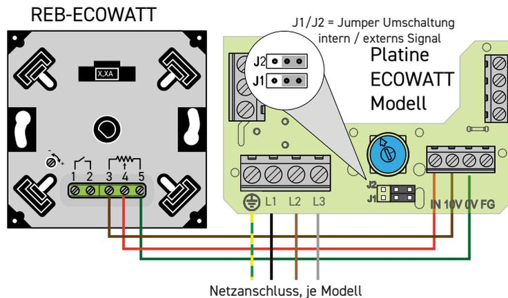
ECOWATT Dachventilator in Verbindung mit CONTROL EC/T Temperaturregler
