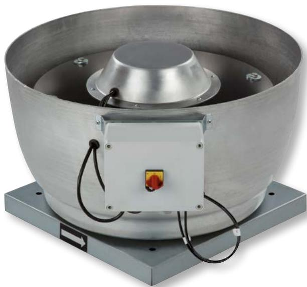
Horizontal ausblasende Dachventilatoren mit Volumenströmen bis 6.280 m<sup>3</sup>/h. Mit integrierter Plug-and-Play-Steuerung, vorkonfiguriert für konstant Druck Betrieb (COP), bei einem Sollwert von 100 Pa.
