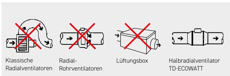
Das niedrige Profil der TD-ECOWATT Ventilatoren macht sie zur effektivsten Lösung für Installationen mit sehr begrenzten Platzverhältnissen, insbesondere in Zwischendecken.
