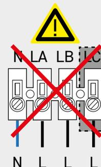
Bei gleichzeitiger Verwendung der Wicklungen LA und LB bzw. Anschluss des Schutzleiters (PE) an einer der Klemmen LA oder LB werden die Motorwicklungen thermisch überlastet.
