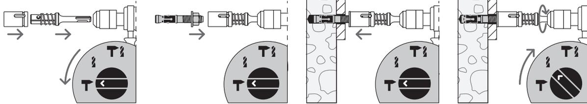
Das Setzgerät FA-ST II mit der passenden Stecknuss in die SDS Plus-Aufnahme des Bohrhammers einstecken bis dieses sicher in der Aufnahme einrastet. Den Bohrhammer auf reine Schlagfunktion umstellen.
