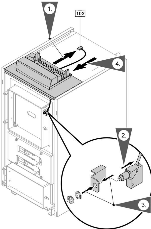
1. Stecker **102** von der Regelung abziehen und Leitung durch die Aussparung im Vorderblech nach außen ziehen.
