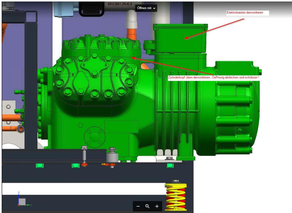
Der Verdichter so weit nach vorne ziehen, bis die Zugänglichkeit zum oberen Zylinderkopf zur Demontage gegeben ist.
