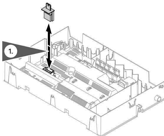
1. Kesselcodierstecker abziehen, Befestigung abschneiden und neuen Kesselcodierstecker einstecken.
