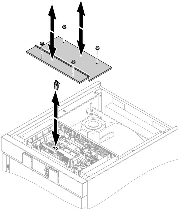
1. Vorhandenen Kessel-Codierstecker herausziehen und Befestigungsband vom Leitungsbaum trennen. Neuen Kessel-Codierstecker einstecken und Befestigungsband am Leitungsbaum befestigen.
