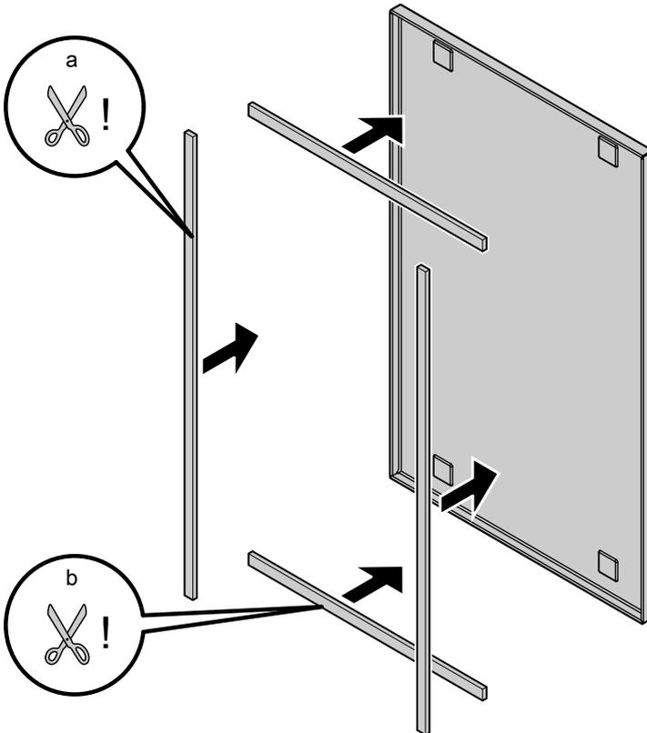
Dichtprofil a / b je nach Gerätetyp entsprechend der Seitenlänge zuschneiden.
