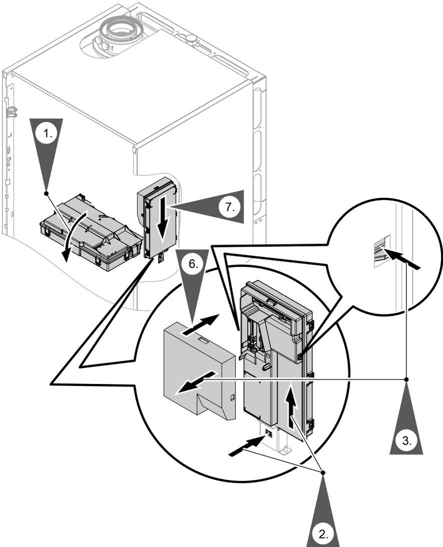
1. Regelungsgehäuse austrasten und nach vorn schwenken.
